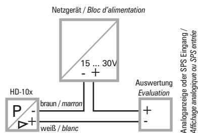
Messkreis mit Speisung durch Auswertegerät /
